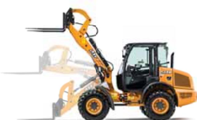
**Z-kinematika** je nejuniverzálnější typ zapojení. Nabízí větší trhací sílu díky 2 zvedacím pístnicím a vyšší vyklápěcí výšku.
